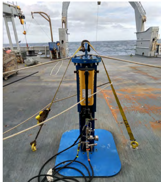
(d) Hydraulic hand pump mounted on tophat
