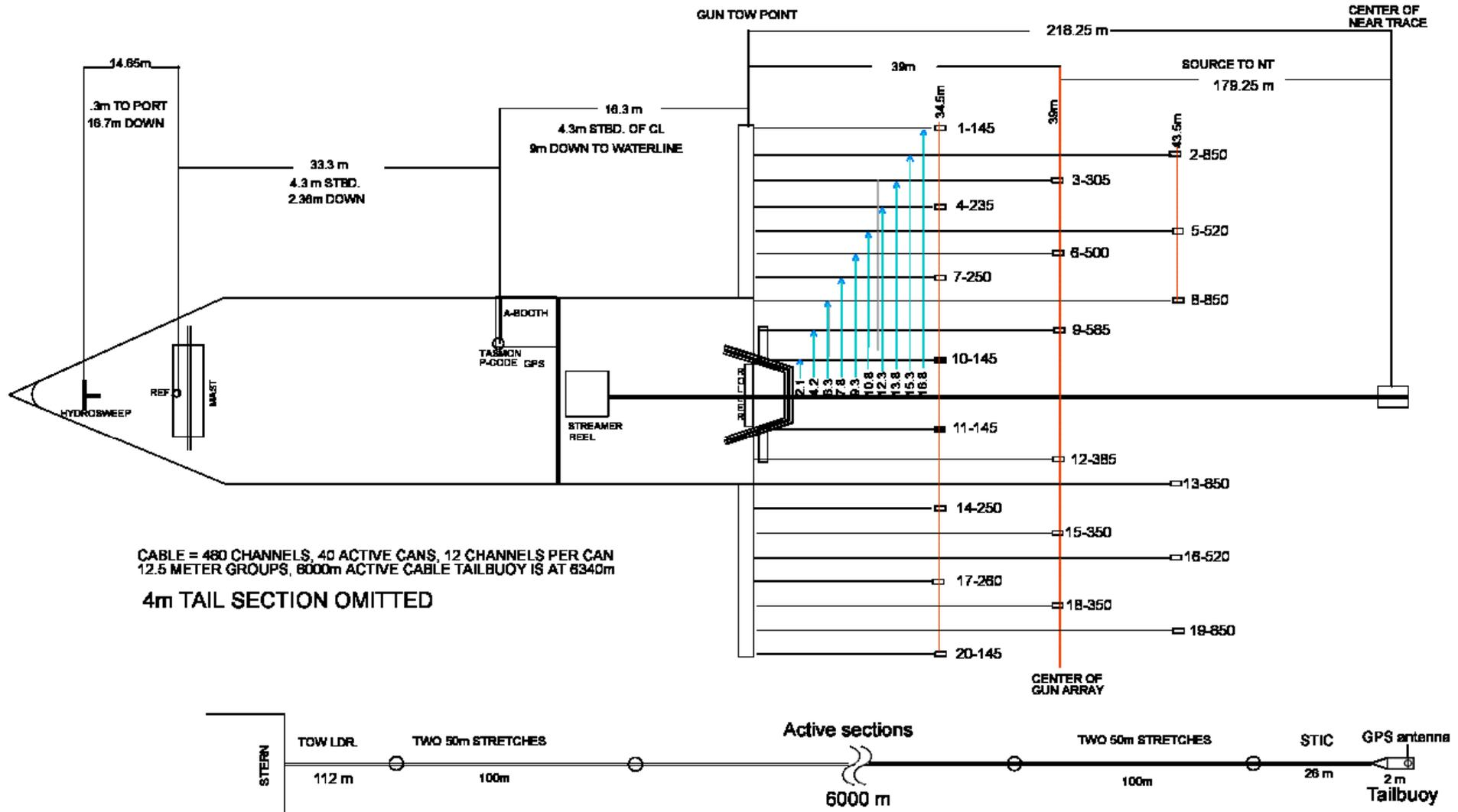
GUNS ARE FIRED WHEN REF. POINT AT THE MAST IS OVER THE PRE-PLOTTED SHOTPOINT.
