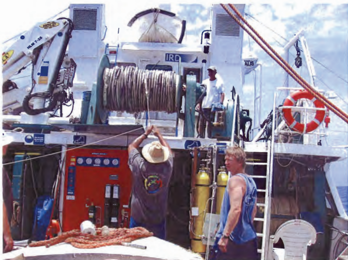
Eléments de sismique utilisés lors de la campagne Sivalis (decembre 2006) Stephen Saustrup au premier plan, Jamie Austin à l'enrouleur de la flûte
