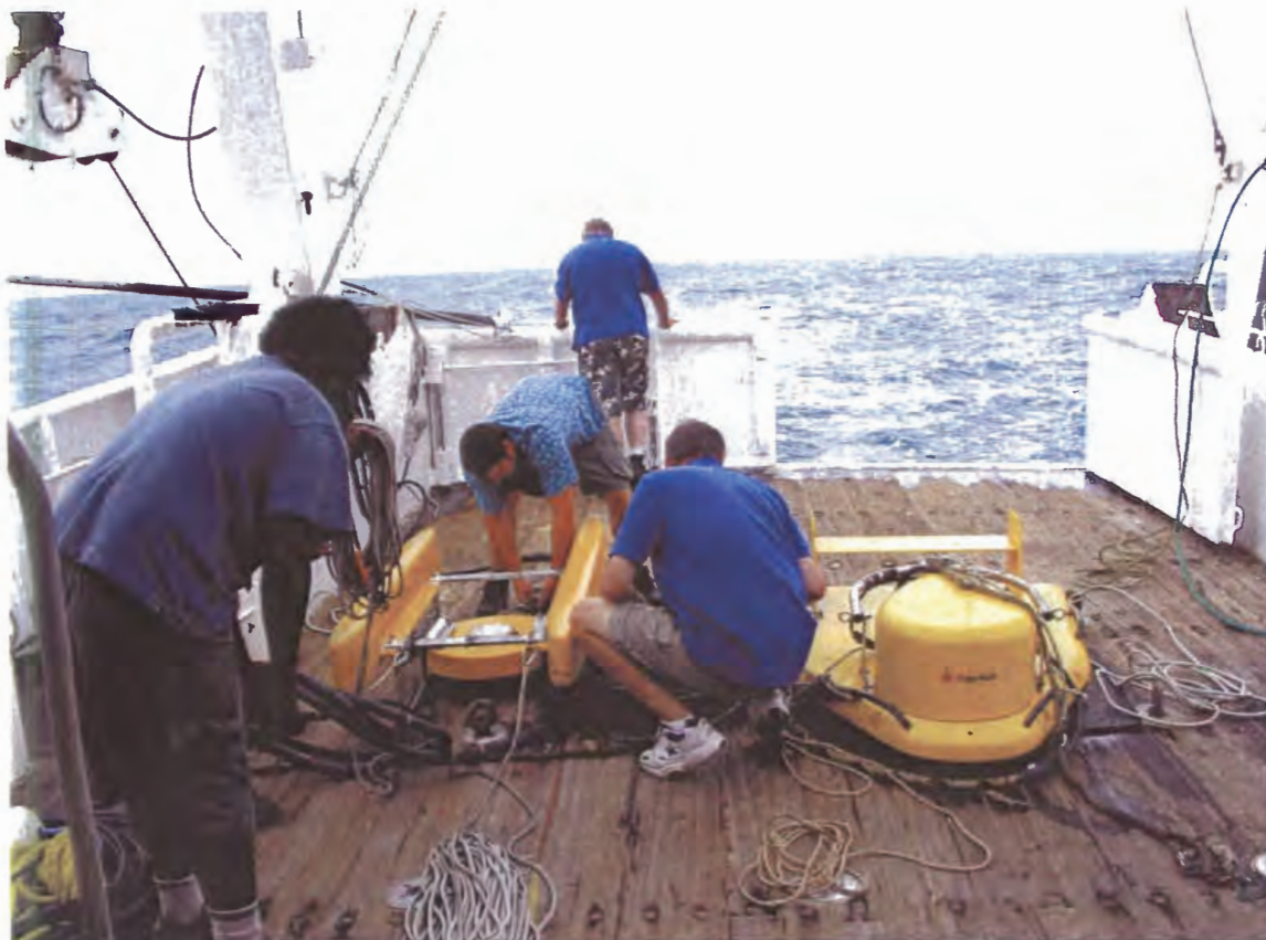
Eléments de sismique utilisés (Boomer et Chirp) lors de la campagne Sabine 2005
